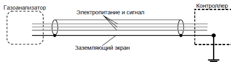
Рисунок 5 – Заземление экранированного кабеля
