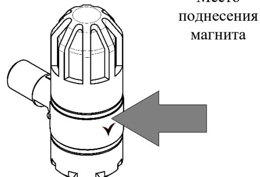
Рисунок Л.2 – Место поднесения магнита
