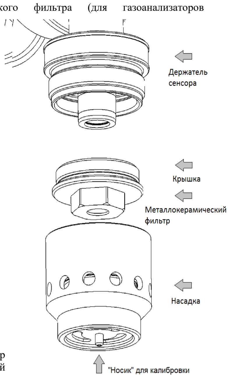
Рисунок 4- Очистка металлокерамического фильтра
