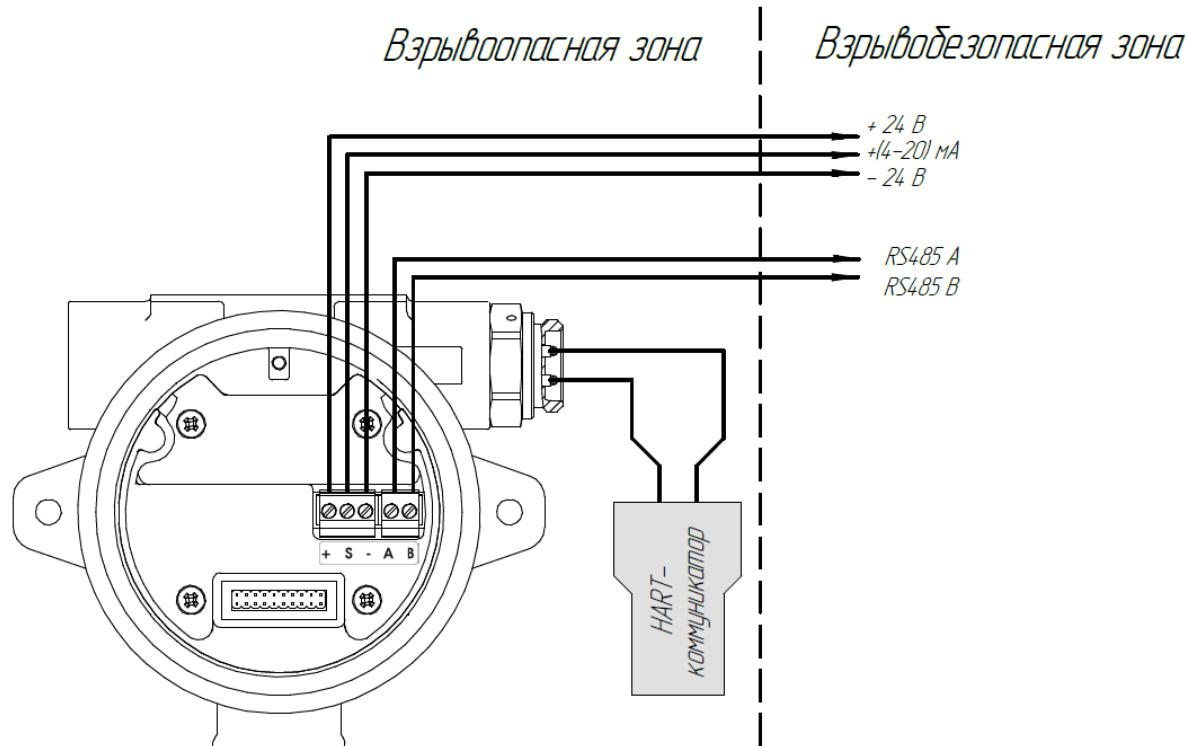
Рисунок Б.3 – 3-проводная схема подключения газоанализатора Газконтроль-04
