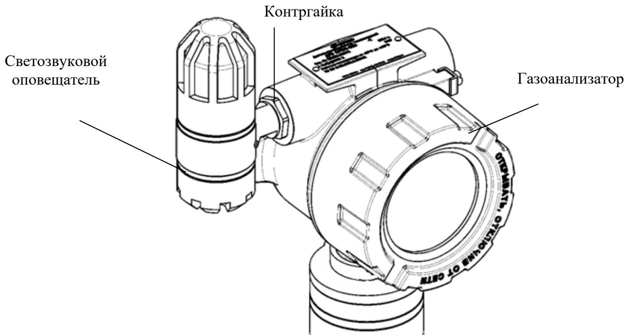
Рисунок Л.1 – Внешний вид газоанализатора со светозвуковым оповещателем
