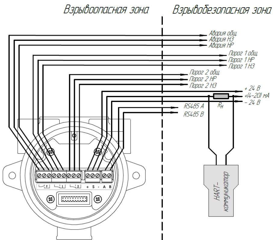
Рисунок Б.2 – 3-проводная схема подключения газоанализатора Газконтроль-04 с реле с подключением HART по токовой петле
