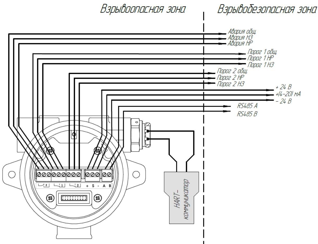
Рисунок Б.4 – 3-проводная схема подключения газоанализатора Газконтроль-04
