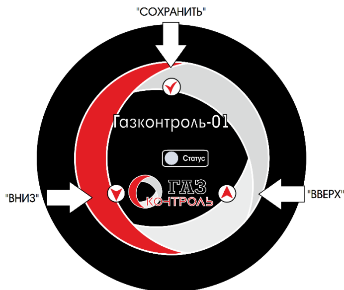
Рисунок Е.1 – Расположение магнитных зон на лицевой этикетке
